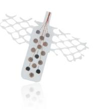
Имплант Digisonic® SP ABI оснащен пластиной с 15 электродными контактами, которая размещается непосредственно на улитковых ядрах ствола мозга. Каждый электродный контакт стимулирует различную область улитковых ядер, что соотносится с определенной частотной полосой акустического сигнала, обрабатываемого звуковым процессором.
